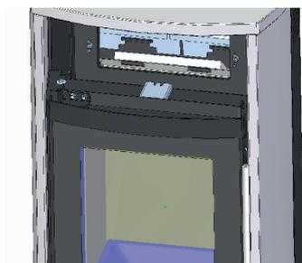
Katalysator hinter dem Teefach
