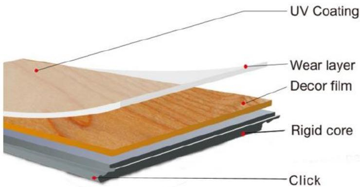
**UV-Lackierung:** UV-gehärteter Lack in zwei Schichten, Auftragsmenge 12-14 g/m<sup>2</sup>
