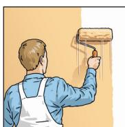
6. Die ERFURT-Strukturvlies Premium ist vorgestrichen. Nach dem Tapezieren ist kein Anstrich erforderlich. Im Renovierungsfall ist das Strukturvlies Premium überstreichbar. Empfohlen wird eine hochwertige Dispersionsfarbe nach DIN EN 13300.
