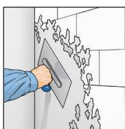
1. Der Untergrund muss trocken, tragfähig, sauber, gleichfarbig und glatt sein. Alte Tapeten und nicht haftende Beschichtungen entfernen. Raue Untergründe mit gipshaltigen Spachtelmassen glätten. Durch geeignete Grundiermittel für einen gleichmäßig saugenden Untergrund sorgen.
