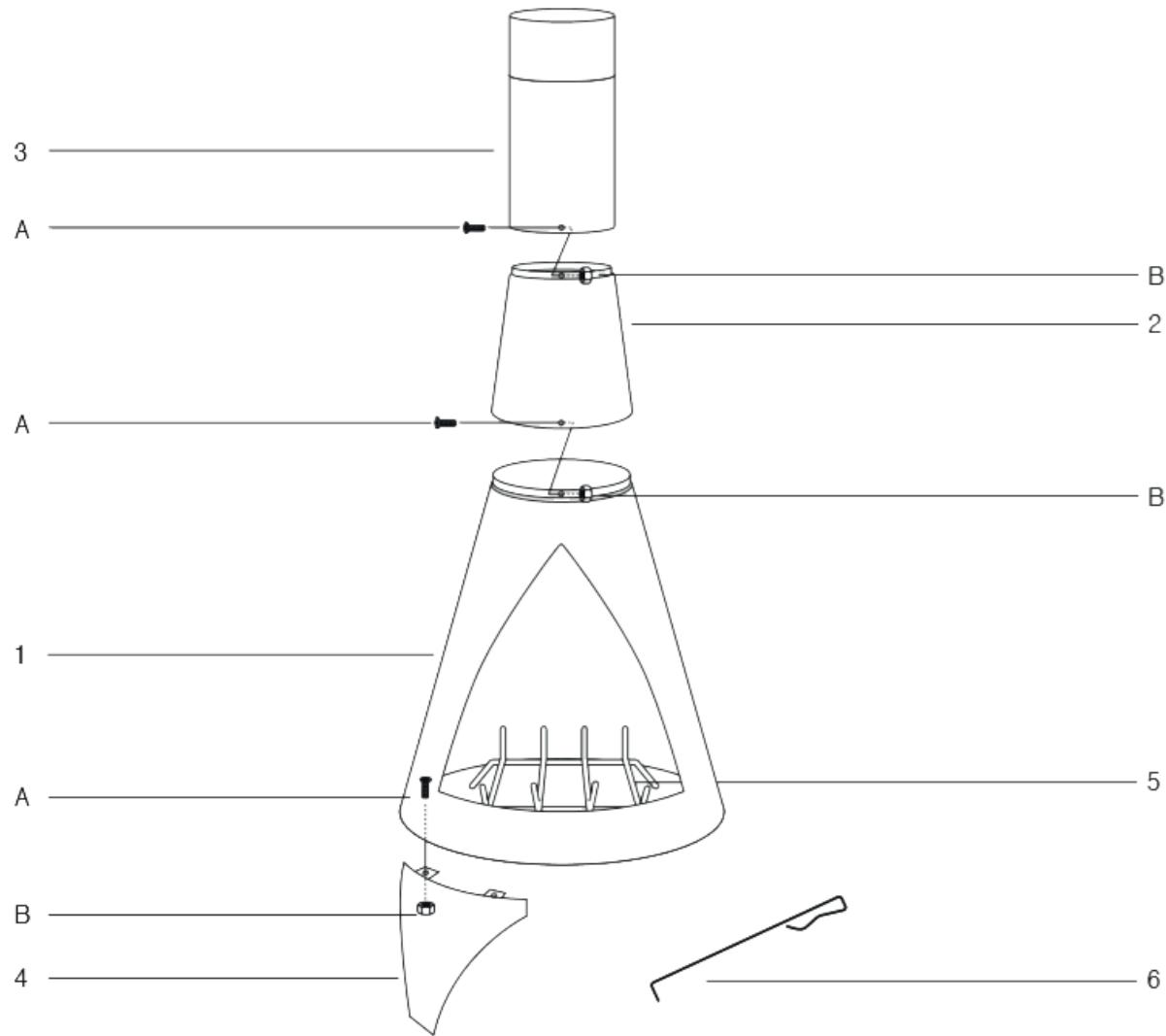
**SCHRITT 1** - Verbinden Sie den Rauchabzug (3) mit dem unteren Abzug (2). Benutzen Sie hierzu 3 x Schrauben (A) und 3 x Muttern (B)
