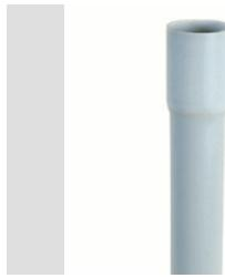
Das System aus mittelsteifen Schutzschläuchen aus hochwertigem PVC bietet überragende Leistung. Erhältlich in Durchmessern von 16 bis 32 mm und in Längen von 2 bis 3 m. Sie können in flexible Leitungen und Anschlusskästen integriert werden. Abgerundet wird das Angebot durch ein breites Sortiment an Kupplungen und Verlegekomponenten mit den Schutzarten IP40 und IP67.
