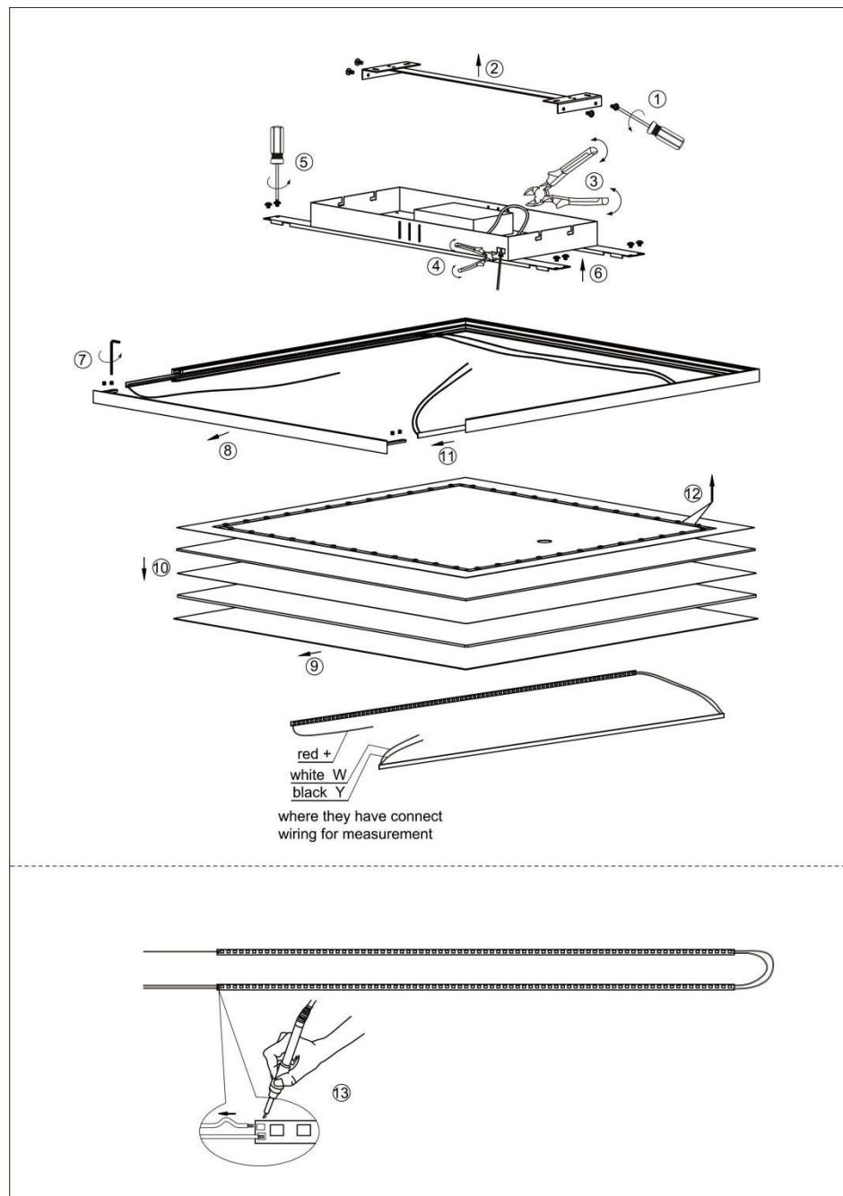
1. Lösen Sie die 4 Schrauben an der Haube
