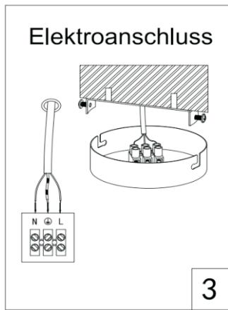
Der Elektroanschluss ist von einer Elektrofachkraft durchzuführen!
