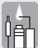
Abb. 4a: Wächterflamme brennt falsch
