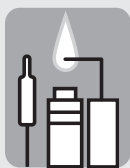
Abb. 4a: Wächterflamme brennt falsch
