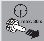
Abb. 3d: Warten und Loslassen des Gasventil-Knopfes
