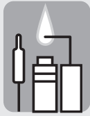
Abb. 4a: Wächterflamme brennt falsch
