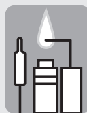
Abb. 4a: Wächterflamme brennt falsch
