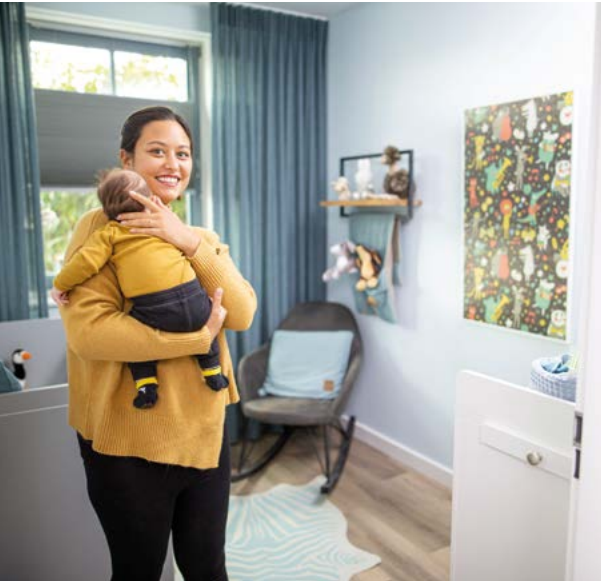
Das Kinderzimmer hat eine Größe von 12 m². Aufgrund der guten Dämmeigenschaft des Raumes wird eine 600 Watt Infrarotheizung der P-Serie verwendet. Bedruckt wurde die Heizung mit einem Wunschmotiv.
