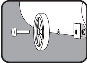
Abb. 1: Montage der Laufräder
