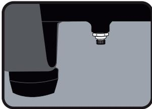
Abb. 7: Wasserablass-Schraube
